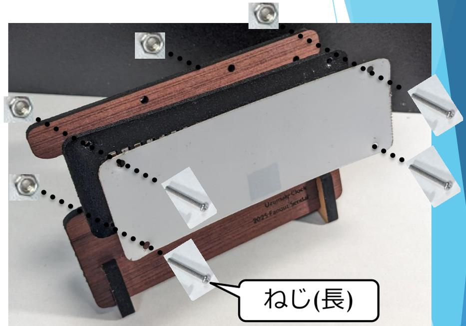
② 木板と遮光板と拡散板を、ねじ(長)とナットで固定する。
