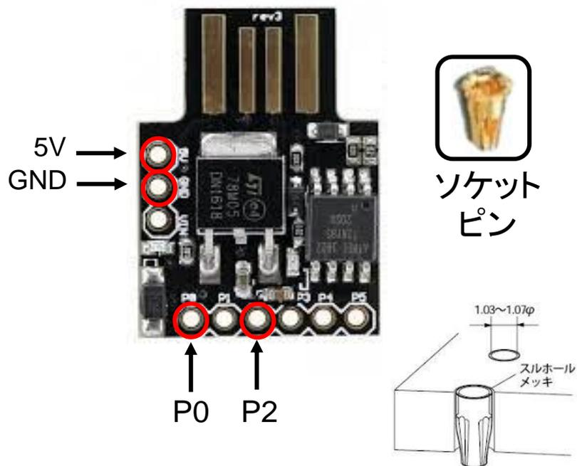
② ソケットピンに、電池ボックスとミニジャックをさしこむ。
